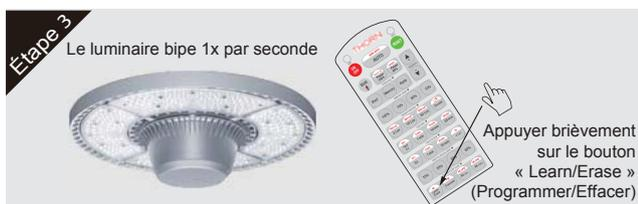
Interrompre le mode d'apprentissage de chaque luminaire en appuyant à nouveau sur « Learn/Erase » (Programmer/Effacer) tout en pointant vers l'œil intelligent. Le luminaire s'arrêtera de bipa. Le regroupement est terminé.
