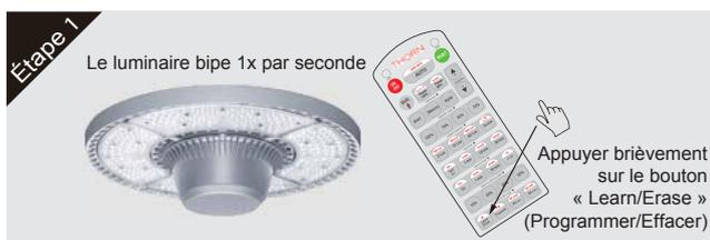
Placer tous les luminaires qui doivent être regroupés en mode de programmation en appuyant brièvement sur « Learn/Erase » (Programmer/Effacer). Diriger la télécommande IR vers l'œil intelligent au centre du luminaire.
