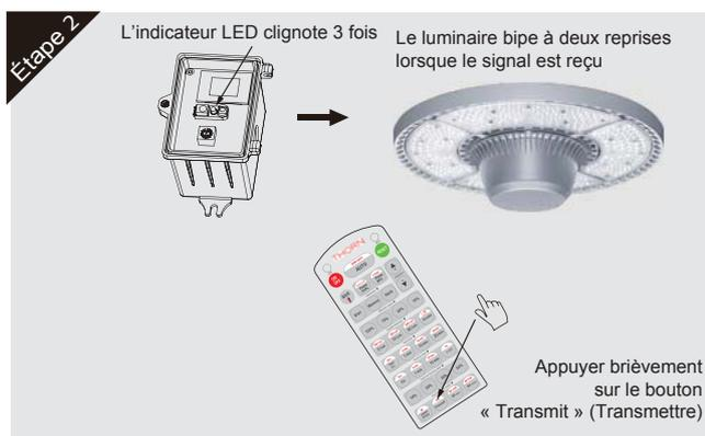
Appuyer sur « Transmit » (Transmettre) vers tous les capteurs qui doivent être appairés avec les luminaires, pour le mode apprentissage. Le capteur clignotera 3 fois et le luminaire bipera à plusieurs reprises.
