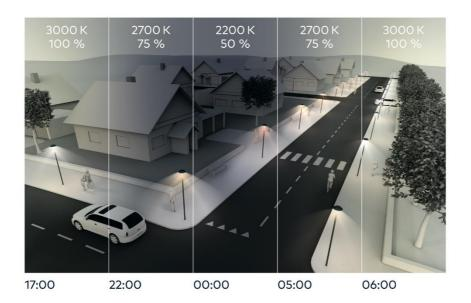
NightTune funziona miscelando la luce dei LED con temperatura di colore calda con quelli a temperatura di colore fredda. Dimmerando i due gruppi di LED separatamente, si possono ottenere temperature colore che vanno da 2200K a 3000K, a differenti livelli di luce.
