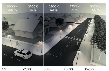
NightTune ermöglicht eine flexible Anpassung von Farbtemperatur und Beleuchtungsniveau im Verlauf der Nacht
